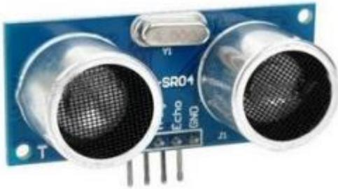
*Figure 13 Capteur ultrasons (lyon, 2018)*
